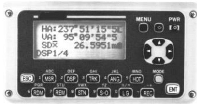
Fig. 1.12 – display e tastiera di stazione totale
