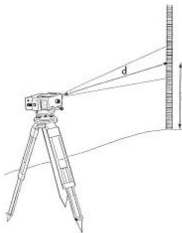
Fig. 1.13 - livello dotato di lettura digitale della stadia
